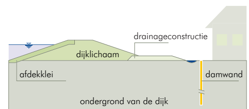
Figuur 4: maatregelen tegen verzakking
