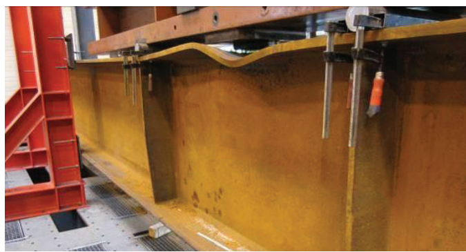
Fig. 23. Comparação entre teste de flexão de 4 pontos e simulação FEA.
