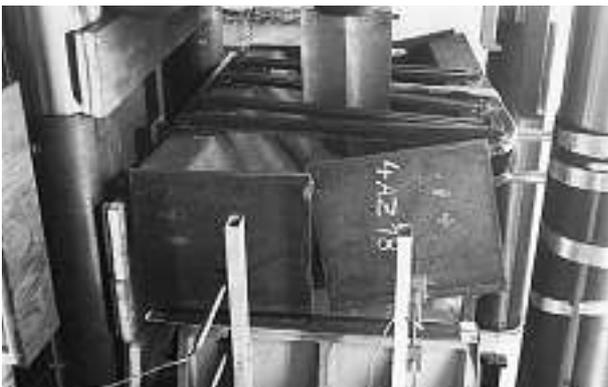
Palplanche double AZ18 dans le banc d'essai
