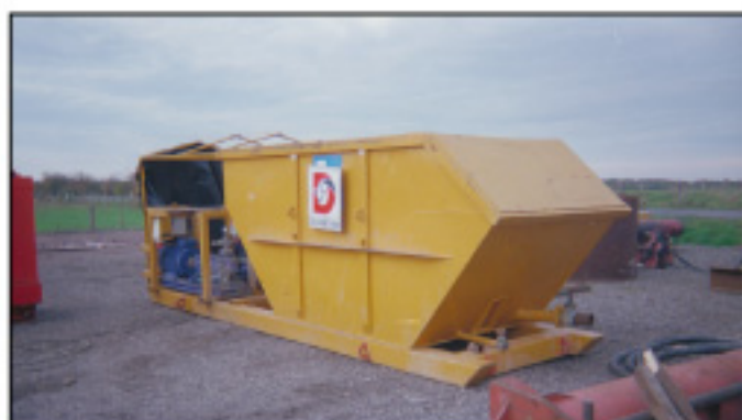
Installation avec citerne et pompe pour petit chantier
