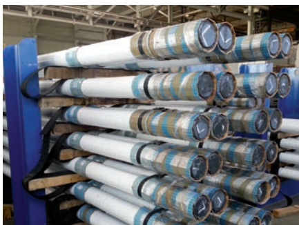
Almacenamiento de tirantes encintados
