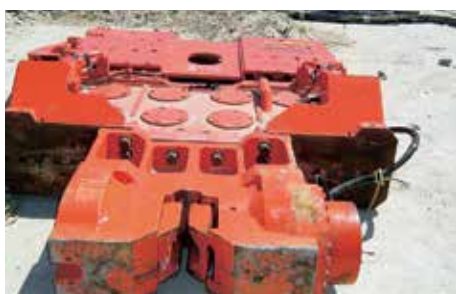
Оборудование для установки свай включало вибропогружатель.
