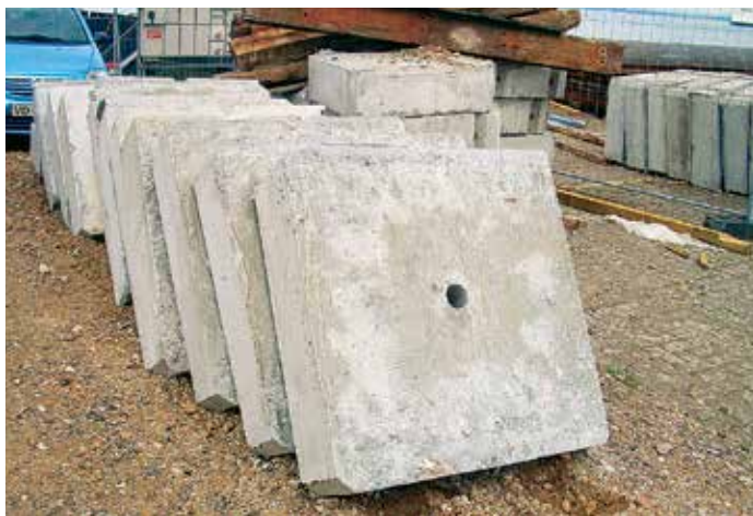
Железобетонная анкерная плита размером 1000 x 1000 x 300 мм.
