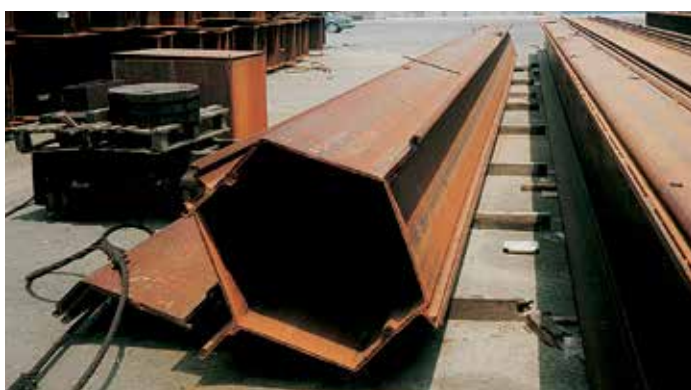
Коробчатая свая типа CAZ 36 с тремя приваренными замковыми соединениями, установленная в месте пересечения анкерных стенок.
