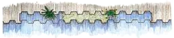
... oder, falls dies innerhalb der Uferbefestigungen vorgesehen ist, in einem Rücksprung in der Spundwand untergebracht werden : Hierdurch wird eine Beeinträchtigung des Wasserlaufs und eine Behinderung der Schifffahrt vermieden.
